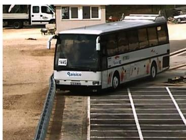
**Ensayo:** TB51 (vehículo pesado de 13.000 Kg. a 70 Km/h y 20°)
