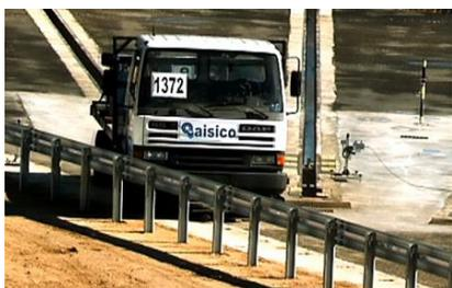
Ensayo: TB42 (vehículo pesado de 10.000 Kg. a 70 Km/h y 15°)
