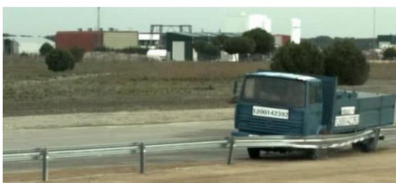
Ensayo: TB42 (vehículo pesado de 10.000 Kg. a 70 Km/h y 15°)
