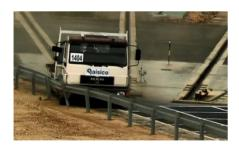
Ensayo: TB42 (vehículo pesado de10.000 Kg a 70 Km/h y 15º)
