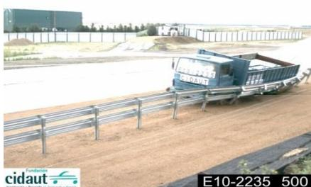
**Ensayo:** TB42 (vehículo pesado de 10.000 Kg. a 70 Km/h y 15°)
