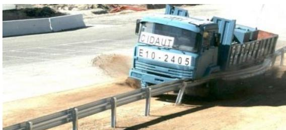
Ensayo: TB42 (vehículo pesado de 10.000 Kg a 70 Km/h y 15°)
